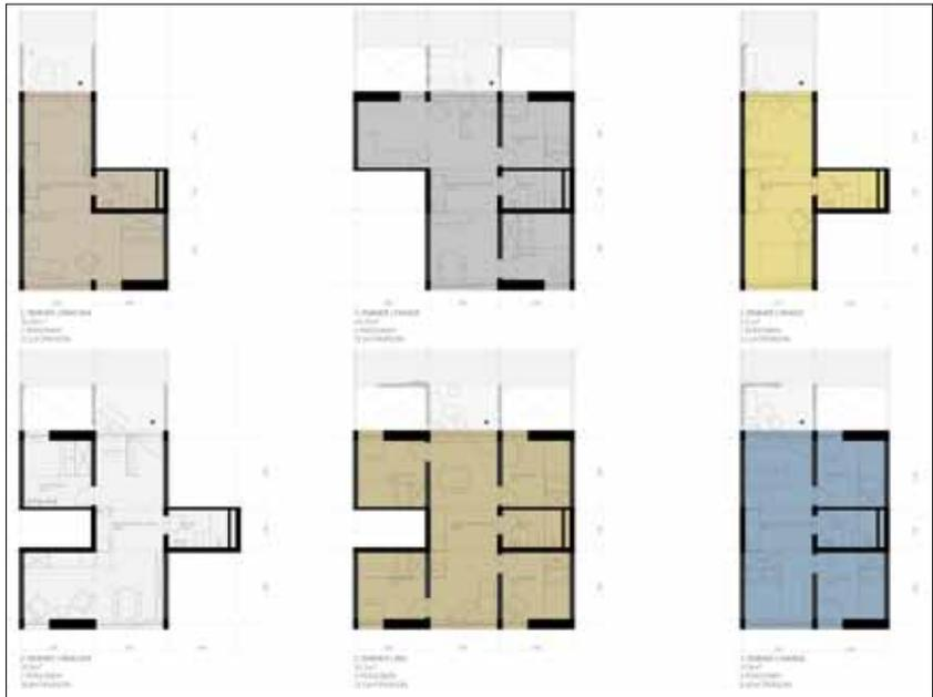
Abb. 4b: Nachweis der Flexibilität der Struktur für „Phase III“: „Micro“-Wohnungen von 1-Zimmer (23 qm) bis 5-Zimmer (52 qm) sind möglich (Entwurf „Kompakt!“)
